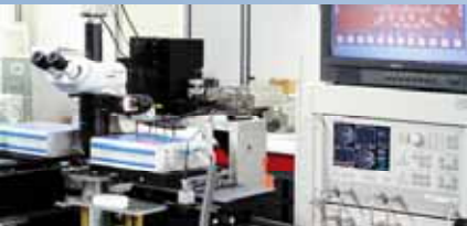
Analyseur de réseau vectoriel 140-220 GHz
