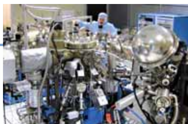
Ensemble de bâtis d'Exipaxie par jets moléculaires : Compact 21 et 32 RIBER
