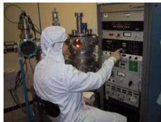
Bâti de métallisation
