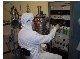
Bâti de métallisation
