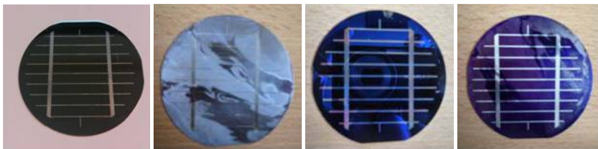
Figure 6 : Cellules solaires types réalisées en TP. De gauche à droite : cellule avec jonction pn seule, cellule avec texturation seule, cellule avec anti-reflet seul, cellule avec texturation et anti-reflet.
