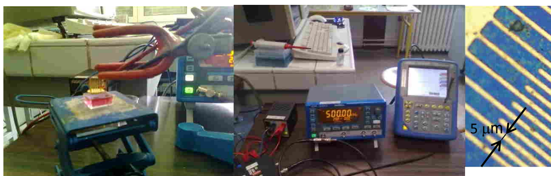
Figure 3 : dispositif expérimental (a) système de préemption du TO8, (b) système de génération des signaux, (c) Image en microscopie optique des peignes interdigités.
