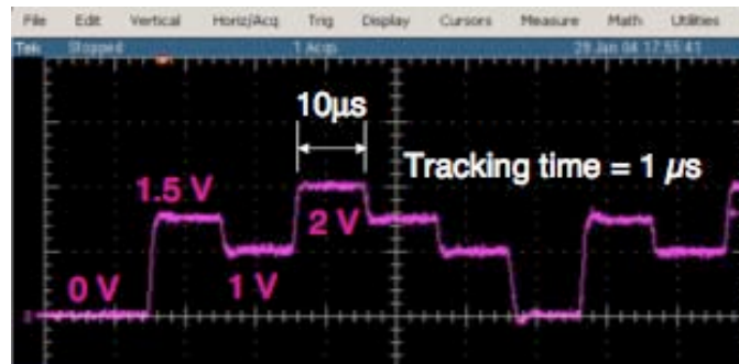
Fig. 7 : Exemple de mesure (de tension) lors de l'expérimentation de stratégie DVS pour la gestion d'énergie.
